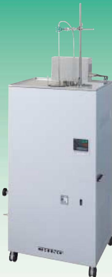
KT-Bシリーズは、熱電対・測温抵抗体・ガラス棒状温度計用の比較温度校正装置です。校正温度範囲は高温用 40～250、中温用 -20～100 の2機種をご用意しています。
