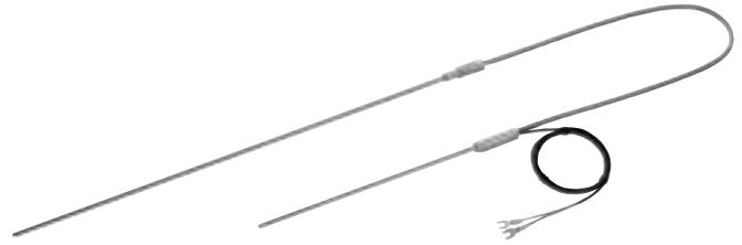
MODEL C820は温度計校正用標準熱電対としてデザインされています。規準起電力値はASTM Vol.14.03 E1751となります。また近い将来はIECに規定される予定です。
