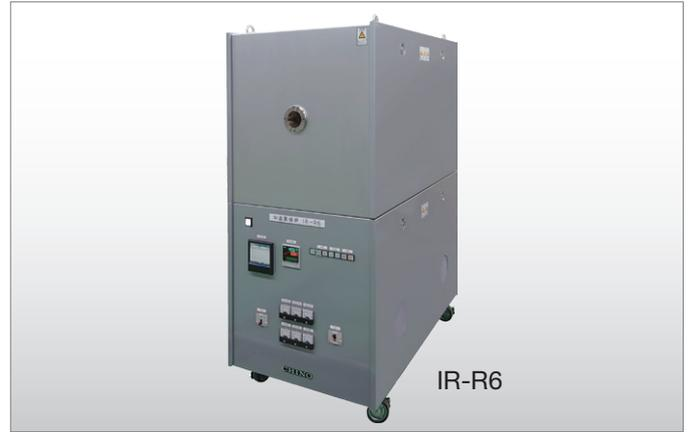
実用精密形比較黒体炉は、200℃から3000℃の温度範囲を3種類の黒体炉でカバーし放射温度計の校正を精密に行います。熱容量が大きく保温性がよいので、温度安定性、均熱性に優れています。
