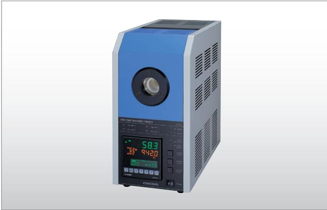
IR-R0Aは、放射温度計を比較校正する標準放射温度計を校正するための標準器です。産業技術総合研究所のご指導のもとに開発しました。
