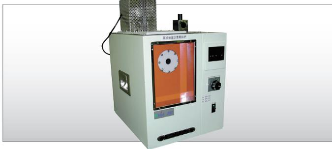
耳式体温計を高精度で校正するために産業技術総合研究所と共同開発した装置で、熱媒体に水を使用した循環式恒温槽形の黒体炉です。温度範囲は30～50℃で基準温度測定には目盛校正された4線式白金測温抵抗体を使用します。
