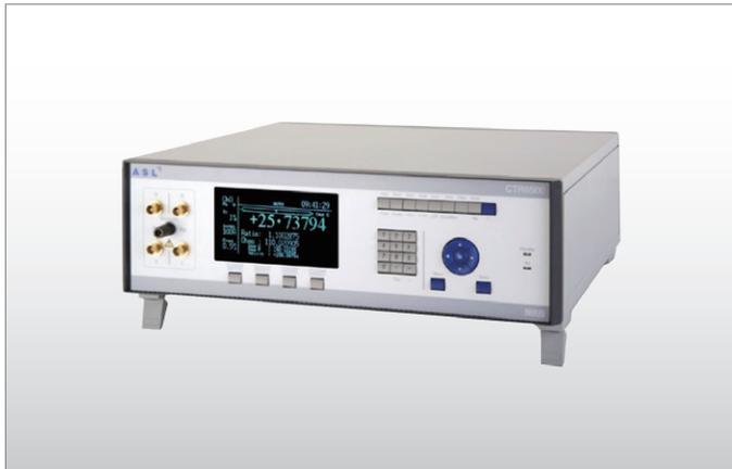
CTR6500は、测温抵抗体用のオートマチック交流抵抗ブリッジです。交流抵抗ブリッジの特長を生かし、優れた安定性、高分解能を実現しています。スイッチボックスを使用することにより、最大60点の入力も可能です。
