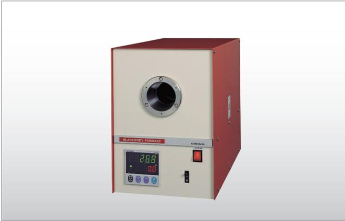
IR-R27は、卓上形の高温用比較黒体炉で、 $0.9\mu\text{m}$ または $0.65\mu\text{m}$ 標準放射温度計\*（別売）を使用し比較校正を行います。
