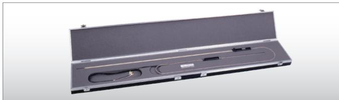
C810は、産業技術総合研究所からの技術移転により商品化された高純度の白金とパラジウムを用いた標準熱電対で、高温での安定性が向上しています。
