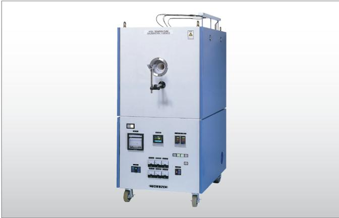
本装置は、校正温度範囲600℃から1400℃の熱電対用温度比較校正装置です。口径60mmの横形管状炉を使用し、3ゾーン分割制御をしているため安定性に優れ、また均熱長が長いいため良好な温度分布を実現します。
