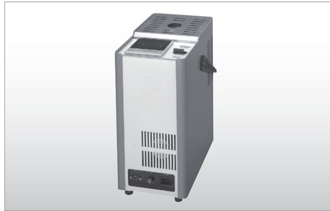
熱電対や測温抵抗体を現場で温度校正するのに向いた小形比較校正装置で、KT-H211は40~400℃、KT-H301は200~1100℃で使用します。
