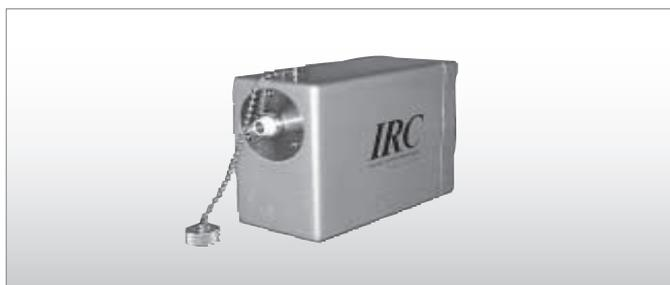
国家計量標準(産業技術総合研究所)の黒体からの温度トレースと各種黒体炉(標準用・試験用・生産用)の黒体の評価に使用する放射温度計です。
