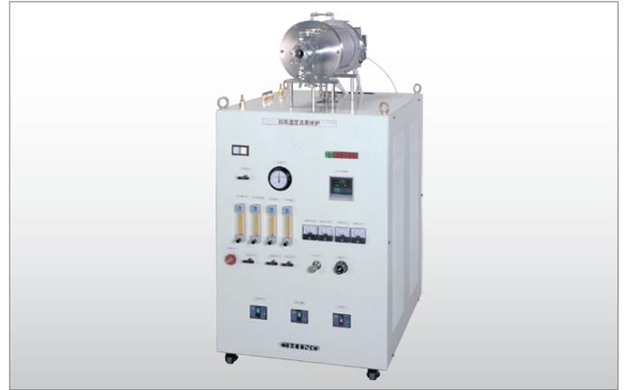
超高温定点黒体炉IR-R80シリーズは、産業技術総合研究所が開発した金属-炭素共晶点を用いた超高温定点黒体炉で、従来銅点(1085℃)までしか達成されていなかった放射温度計定点校正の高温化(2474℃まで)を実現しました。装置は炉本体と定まるつぼから構成され、定まるつぼの交換により各種定点の実現が可能です。
